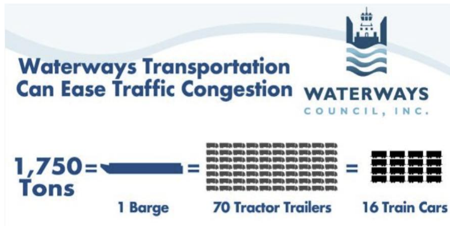
Figura 2. Quantas Barcaças, Vagões e Carretas são Necessárias para Transportar 1.750 Toneladas de Carga.
